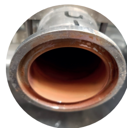
Exemple de rouging de type 1
